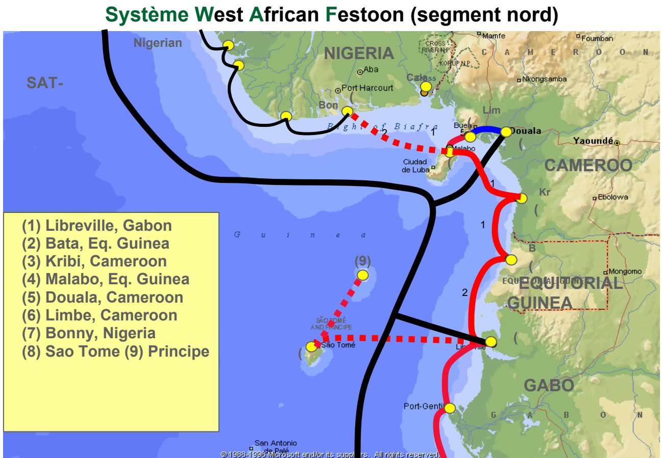
Figure 8 : Configuration du système WAFS (Segment Nord)
